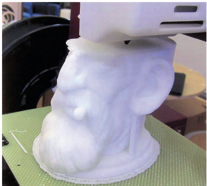
Abb. 2 Ein 3D-Drucker modelliert ein Objekt nach einem vom Computer errechneten Bauplan, indem er einen besonderen Kunststoff in hauchdünnen Schichten aufträgt.
